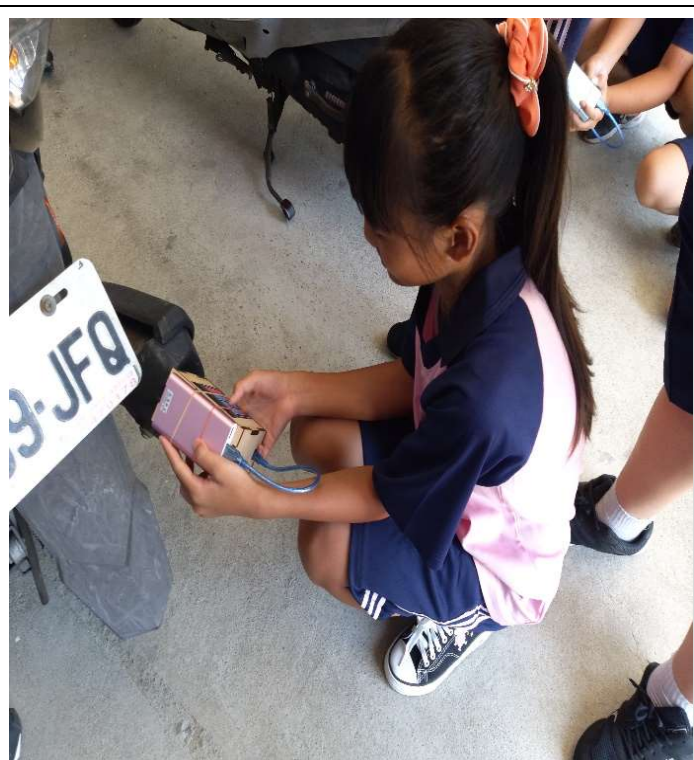
說明二：學生正在利用攜行式空氣盒子測試摩托車排放出來的廢氣 PM2.5
