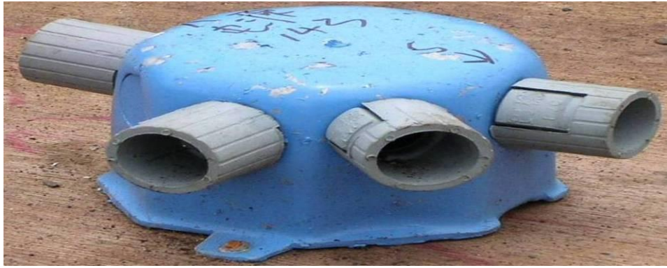
〈照片九-2〉六角出線盒加深型正確控制保護層
