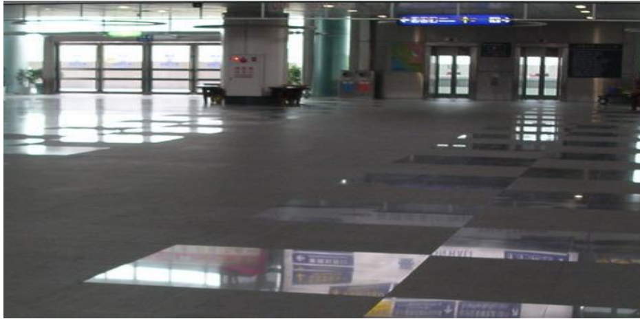
〈照片五-2〉 摻雜光面及燒面石材地板以符合使用功能
